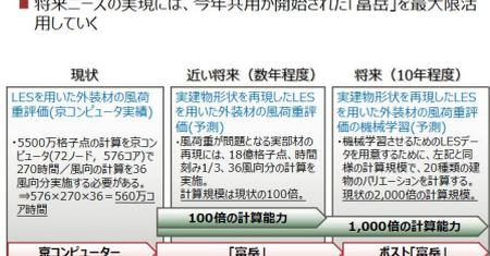
図：ニーズ実現に必要な計算量の見直し(高層建物の耐風設計・風荷重等を最適化する外装材の形状設計支援)
